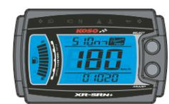
Wenn Sie die Höchstgeschwindigkeit (180 km/h) erreicht haben, beendet das Messgerät das Messen der Strecke (510 m) und der Zeit (10,20 Sekunden).
