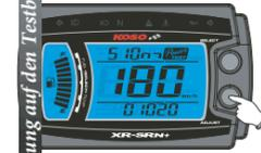
Drücken Sie die **Einstellstaste**, um die Aufzeichnung zu löschen und auf den Höchstgeschwindigkeit-Bildschirm zu gelangen.
